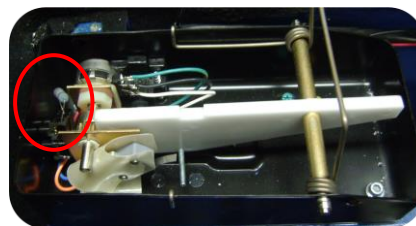
1 resistor 220 OHMS no pedal do acelerador(3)
